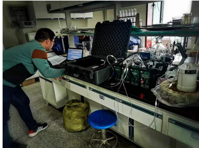
Q-BOX SR1LP 土壤呼吸可以用于原位土壤呼吸测量、发酵研究，细菌呼吸研究。
