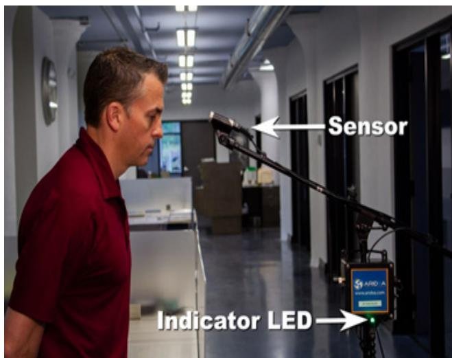
Aridea 要求 APOGEE 公司制造一种定制的红外辐射计，型号为 SI-4B1-SS，具有更紧密的校准范围，聚焦于人体皮肤温度，并具有 SDI-12 数字输出。Aridea 创造了一个围绕远地点传感器构建的易于使用的系统，并很快推出了这一新的人体体温快速筛查系统，该系统已在世界各地的几家工厂和场所部署。Apogee 提供的这种设备，在这个充满挑战的时期已经适应了这种用途。
