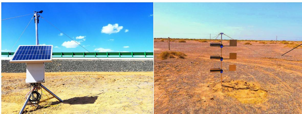
集沙盒分三层排列（上图为定制款）；内含特制轴承，转动灵敏度高；每层布局一套风沙收集盒组件；集沙盒材质为 304 优质不锈钢；特殊设计的拉拔式集沙盒，便于安装、采集沙样；超过三层，可选配风缆绳加固。支架有定制款底座，方便安装。可订制多层。
