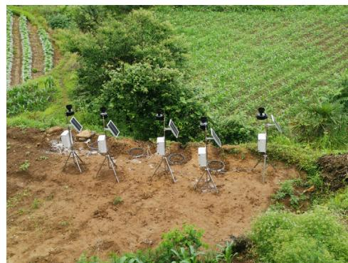
此套蒸渗系统共有 5 个蒸渗观测桶，使用双层桶布局方案，能够快速部署安装；使用高精度称重传感器作为重量变化检测元件。该研究所利用这套设备，主要用来研究农作物生长量与降雨量之间的关系，开展农作物需水量及蒸腾蒸发规律实验研究，以及农作物受旱、受渍、积水实验及优化灌溉制度的实验研究等方面问题。
