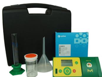
RQflex 20 是一套较为全面的土壤分析套件，适用于实验室或野外现场操作。检测项目包括：氨、镁、钙、余氯、甲醛、铁、硝酸盐、亚硝酸盐、酸碱值、磷酸盐、钾、亚硫酸盐、总酸度、总硬度等。
