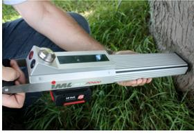
PD 系列针测仪不仅可以记录测量时转针收到的阻力，还能测量进力，操作者对不同种类、不同腐烂程度树木的判断更加准确。
