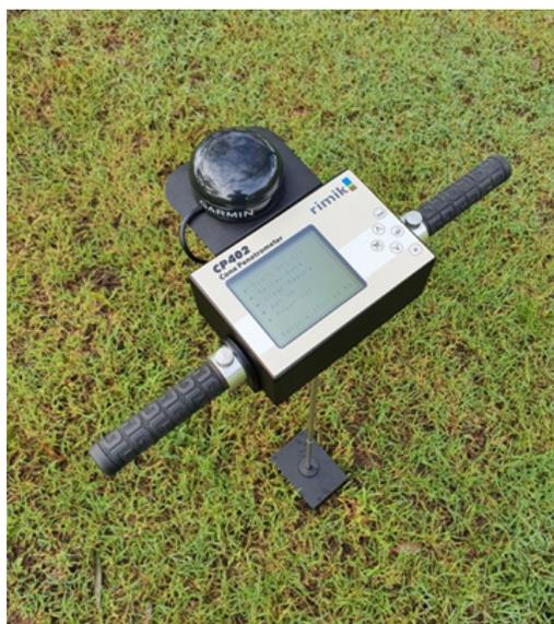
CP402 土壤紧实度仪为便携式野外用来测量土壤紧实度的仪器。可显示测量深度，插入速度及土壤紧实程度。通过配套的软件可以分析数据并绘制出紧实度随深度变化的曲线图形等。可接 GPS 接收机。紧实的土壤可阻止水分的入渗，降低化肥的利用率，影响植物根系生长，此仪器可以很好的指导耕地方式。
