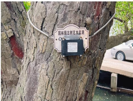
无线传感器设计，内置加速器，监测每棵树的倾斜角度，定时发送数据到云端服务器，树木的倾斜角度大于设定的临界角度时，系统发出警告信息，提醒管理人员关注，以及及时采取适当的风险管控措施。
