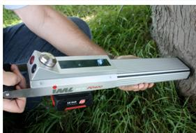
PD 系列针测仪不仅可记录测量时转针受到的阻力，还能测量进力，操作者对不同种类、不同腐烂程度树木的判断更加准确。
