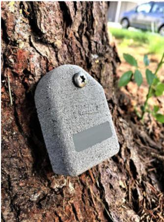
TMS3 树木稳定安全性测试仪用于测量树根的锚地程度及树木的稳定安全性。当风吹动树木，树木开始摇动，负荷传到根部，TMS 3 记录树木的动态摇摆运动。根据 Wessolly (Wessolly & Erb, 1998) 的发现，利用静态拉伸测试能够测量树木根部安全稳定性。在静态拉伸测试时，树木受到来自绞车或绳索的负荷发生倾斜，与周围其它树木进行比较，可以得出树木所受负荷的大小。将人为施加负荷与自然风引起的负荷对比，通过专业软件分析，确定自然风引起的负荷大小。
