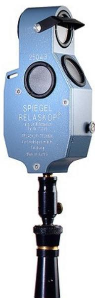
Spiegel Relaskop 林分速测镜是一款林业上广泛应用的综合性的袖珍光学测树仪，主要用来测定树高、立木任意部位直径、水平距离、坡度和林木每公顷胸高断面积总和等多项因子，从而可以计算出林分蓄积量。1948 年奥地利林学家沃尔特·毕特利希首创了角规测树理论和方法，打破了 100 多年来的标准地每木检尺的传统方法，只在一个点上用水平视角绕测周围树木，大大提高了森林调查的工效，实现了测树技术的巨大飞跃。Spiegel Relaskop 林分速测镜是一款高效和经济的清查工具，是林业上应用较为广泛的一款森林调查仪器，主要用以角规测计单位面积上的胸高断面积，在坡地上使用时，能自动调整坡度影响，直接读得胸高处断面积以及任何高度的断面积，被林学家称为林业科学领域的“世纪发明”。
