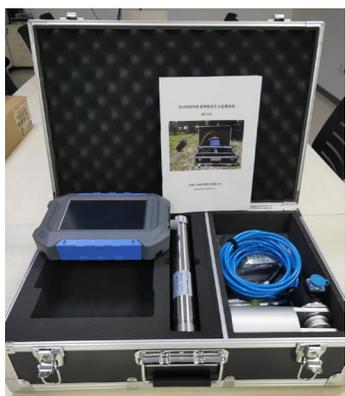
DJ-3012 植物 3D 根系生长监测系统采用微根窗技术，结合 3D 全景成像，一次性获取整个根管的剖面图像，用于土壤中活体根系的生长动态研究。
