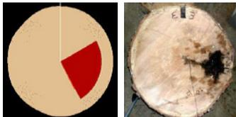
不同颜色表示不同的木质结构，红色代表成型的腐烂，紫红色代表近树皮处腐烂，绿色表示早期腐烂，棕黄色表示实木。
