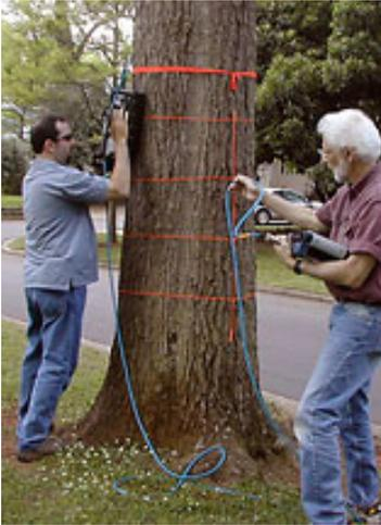
TRU 树木雷达检测系统是为检测树木内部结构损伤程度而设计的。它利用地面雷达探测技术对树木进行非侵入式扫描，并可以清晰成像。
