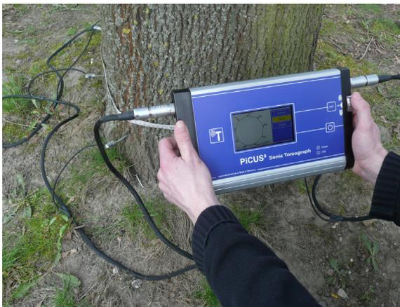
Picus-3 弹性波树木断层画像诊断仪用于检测因虫害或者自然衰退导致树木木质腐烂情况，多数情况下主要测量树干近地面的部分。测量时将传感器固定在预检测的断层上，使用专业设计的电子锤敲击每个检测点，弹性波在树干内部传播，如果树干内部的介质不同，波传播的速度就不同，进而可以判断树干内部的健康状况。
