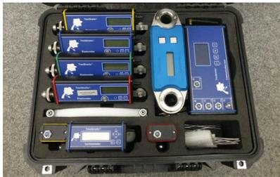
TreeQinetic 树木拉伸测试仪用于检测树干和根部受外部拉力时的稳定特性。该装置可对树木稳定性进行精确且无损伤的测量。测试时，通过绞盘和钢丝对树干施加拉力负荷（模拟风的影响），树木的反应由弹性测试仪和测斜仪进行测量，并将数据与坚固的树木进行比对。影响计算的主要因素是负荷的相关特性（受力处结构和树高等）和树木本身的性质。
