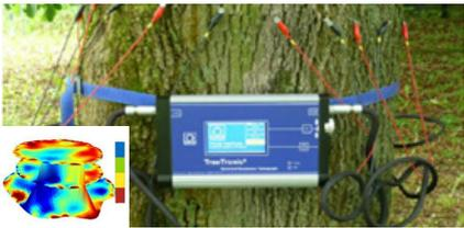
PiCUS 树木电阻抗断层成像仪通过测量电流或电压的变化来诊断树木情况，测量结果以二维图像的形式进行显示，该图像表示树木的电阻抗变化，简称 ERT (Electrical Resistance Tomogram)。影响树木电阻抗变化的主要因素是树木水分，以及通过树木的状态和细胞结构而改变的化学元素（应力木或者根相比于正常的树木有不同的电阻抗）。
