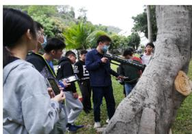
钻针钻进树木时，同步打印钻针前进时受到的阻力，结果也在微电脑内存储。木质结构完整，钻针阻力大，木质腐烂，阻力小。
