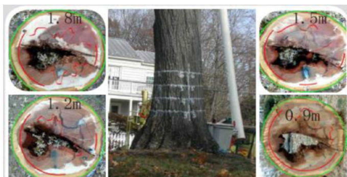
项目案例：200年古橡树，红色曲线显示雷达波探测到的界面——实木和受损木材之间的分界面
