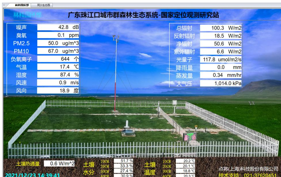
该气象场包含了 10 米风速风向、空气负离子、噪声、PM2.5PM10、臭氧、空气温湿度、气压、雨量、蒸发（自动开）、土壤表面温度、土壤温度（4 层：10cm、20cm、30cm、40cm）、土壤水分（4 层：10cm、20cm、30cm、40cm）、土壤热通量、总辐射、光量子、紫外辐射、日照时数、反射辐射、净辐射等十数种有效参数，通过物联网将数据传输到林业系统平台，同时也在部分场所对外展示。
