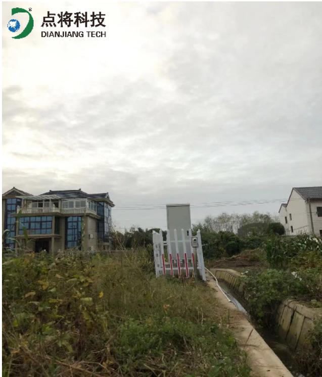
4号农业生活雨水排水口，部分水会由此处汇聚至入河口并对沟渠内的水质采样并长期监测流量、电导率以及浊度
