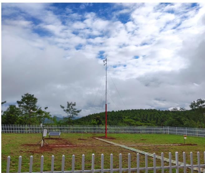
标准气象观测站是集成站，用于对风速、风向、雨量、气温、相对湿度、太阳总辐射、光合有效辐射、气压、土壤温度、土壤水分、土壤电导率这十二个气象要素进行测量，进行全天候自动监测。配合软件可以实现网络远程数据传输和网络实时气象状况监测。
