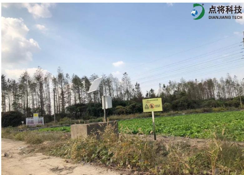
1号农田排水测量点，采用安装排水管并将农田水汇聚到一个点来进行长期测量农田排水量，并长期监控农田排水电导率、浊度，降雨量和两层土壤三参数。
