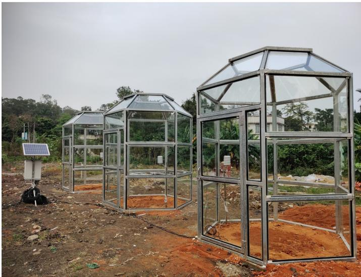
本实验采用六个等腰梯形围城一个上下均开口的多面体，顶面和底面的中心位于同一竖直线上。该结构适用于植物生态系统的增温模拟实验，特别是采用上下均为正六边形开口以及顶面小于底面的设计，充分考虑了空旷区植物低矮，风速较大，光照强烈的环境特点，能够准确的模拟植物生长的增温过程。
